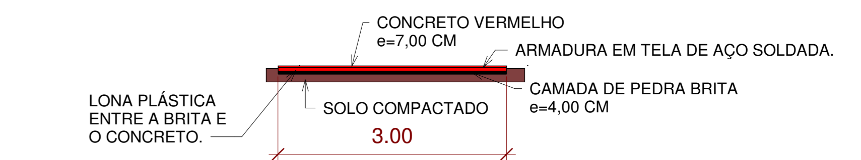
7 CORTE CONCRETO VERMELHO 1 : 50
