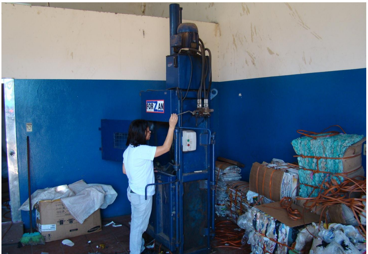
Imagem 34: prensa para a compactação e enfardamento dos materiais recicláveis após sua separação.
