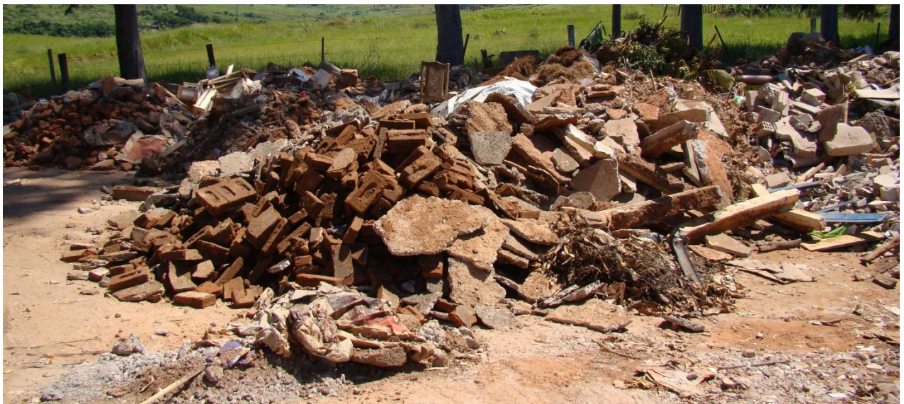
Imagem 45: resíduos da construção civil, depositados em área de transbordo.
