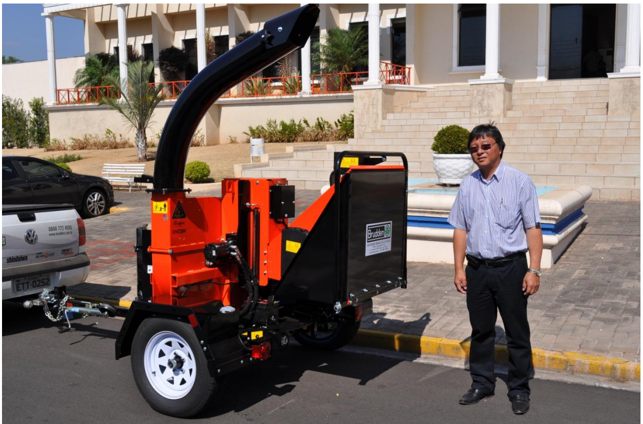
Imagem 39: triturador de galhos, utilizado no processo de produção de compostagem.
