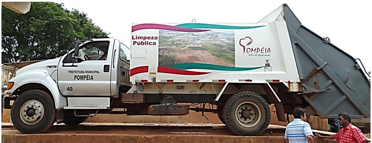
Imagem 10 – Caminhão compactador (placas BPZ-3569), utilizado no serviço de coleta convencional.
