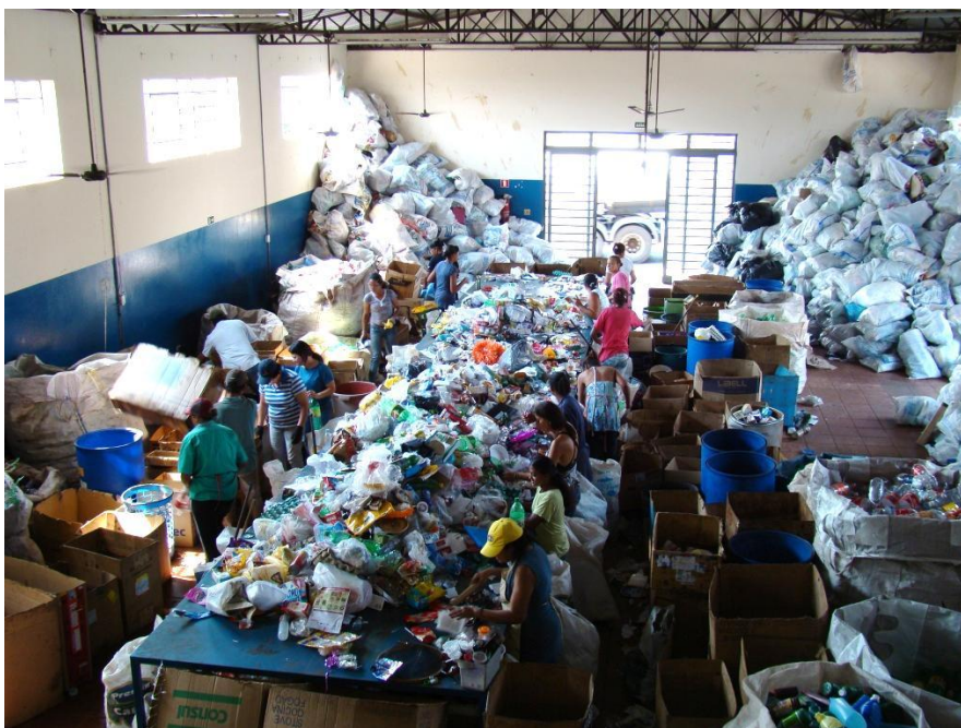
Imagem 28 – vista interna do centro de triagem, ocasião em que os associados realizam a separação dos recicláveis por tipo de material; no início do Programa de Coleta Seletiva, o centro de triagem contava apenas com uma mesa metálica para a realização dos trabalhos de separação.
