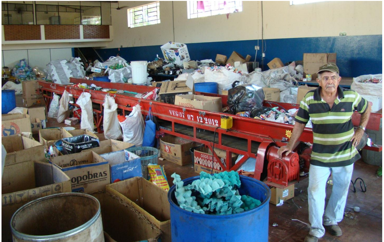
Imagem 33: esteira de triagem, adquirida em 2013, vindo a substituir a mesa metálica utilizada anteriormente.
